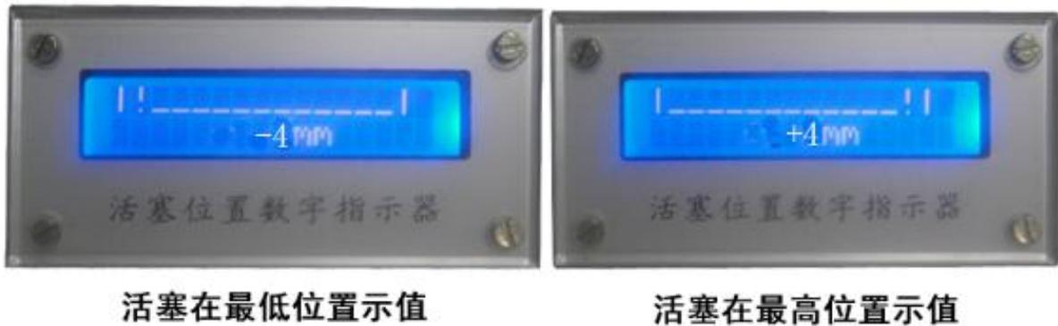
d. 位移指示校准：当位移示值不准确时，长按黄色位移校准按钮，当液晶出现“L”时放开，将活塞置于最低位置，待液晶上数字稳定后按一下按钮，当液晶上出现“H”时，将活塞置于最高位置，待液晶上数字稳定后按一下按钮，即可完成活塞的位移校准。
